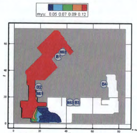
Рис. 142. Оптическая плотность дыма ( H_n/m ) в горизонтальном сечении на высоте 1,7 м от уровня пола в момент времени 170 с
