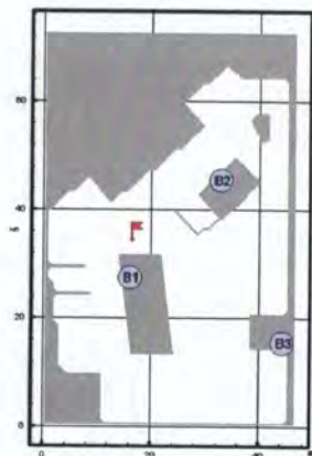
Рис. 125. Расчетная схема первого сценария развития пожара (горизонтальное сечение на высоте 1,7 м от уровня пола):
