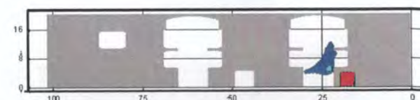
Рис. 49. Оптическая плотность дыма (Hn/м) в вертикальном сечении 1-1 в момент времени 120 с
