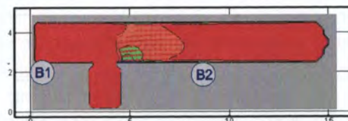
Рис. 164. Оптическая плотность дыма (Hn/м) в горизонтальном сечении на высоте 1,7 м от уровня пола в момент времени 190 с
