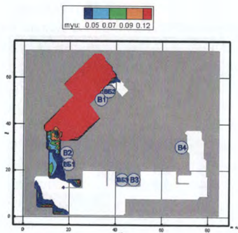
Рис. 141. Оптическая плотность дыма ( H_n/m ) в горизонтальном сечении на высоте 1,7 м от уровня пола в момент времени 120 с
